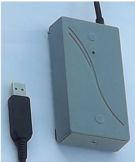
Leitor Mesa dim 114 x 61 x 22 mm
