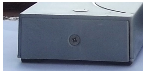
Retire a tampinha para acessar a DipSwitch
